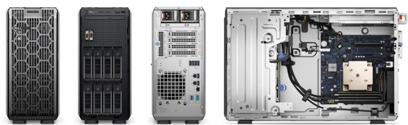
보안 베젤 설치 전면 8x 3.5" + BOSS-S2 새시 전면 4x PCIe / 듀얼 파워 새시 후면 새시 내부
